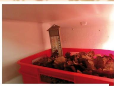
▲ Min-Max-Thermometer zur Erfassung der Temperaturschwankungen.
